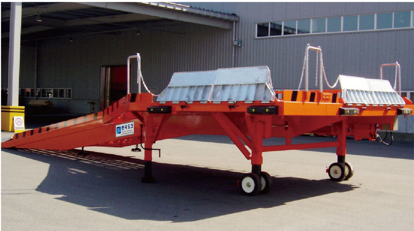
수평부에서 지게차의 직각(90도) 회전이 가능하여 컨테이너 차량과 일직선상에서 작업하기 곤란한 장소에서도 하역이 가능한 모델
