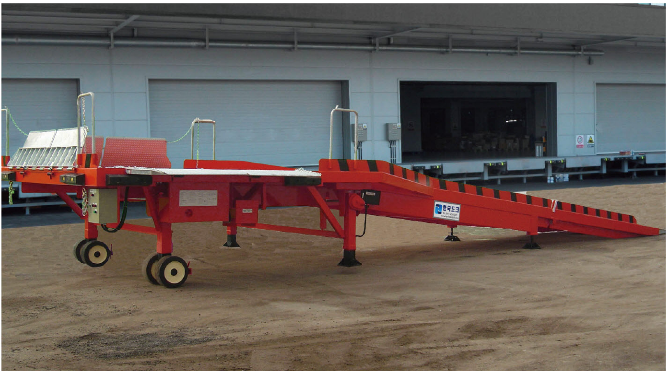
넓은 수평부에서 지게차의 좌·우 직각(90도) 회전이 가능하여 다양한 방향에서 컨테이너 하역작업이 가능한 모델
